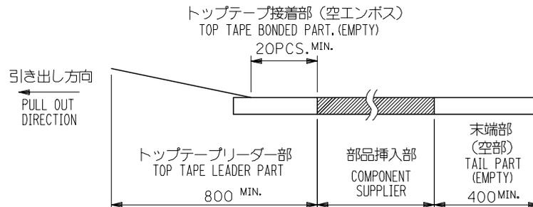
4. トップテープの剥離強度：0.1N～1.3N (10.2gf～130gf) (剥離方向は下図参照) 尚、本規格値は出荷時に適用。(但し、輸送時に剥離が発生しないこと。)
